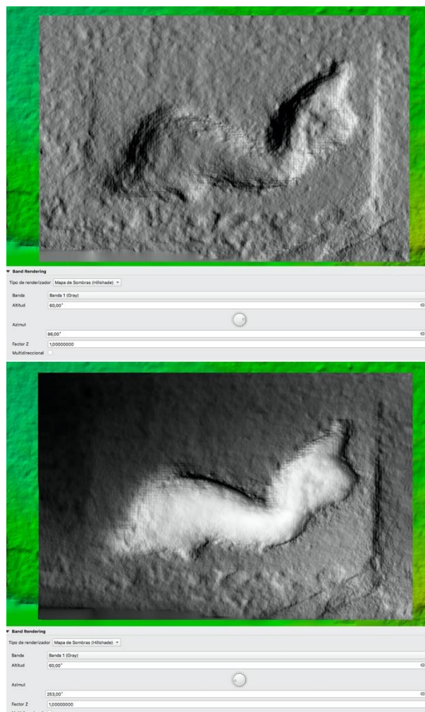
Figura 10: Herramienta hillshade aplicada con diferentes parámetros sobre un mismo MDE.
