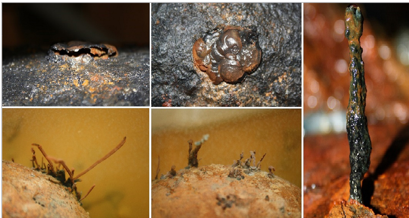
Figura 6.- Afloraciones aparecidas en la superficie de las piezas tras 24 horas sumergidas en una disolución de NaOH 5M en agua corriente y pH 13,4 \pm 0,6 . Fotografías de archivo de Aula3 AIP S.L.
